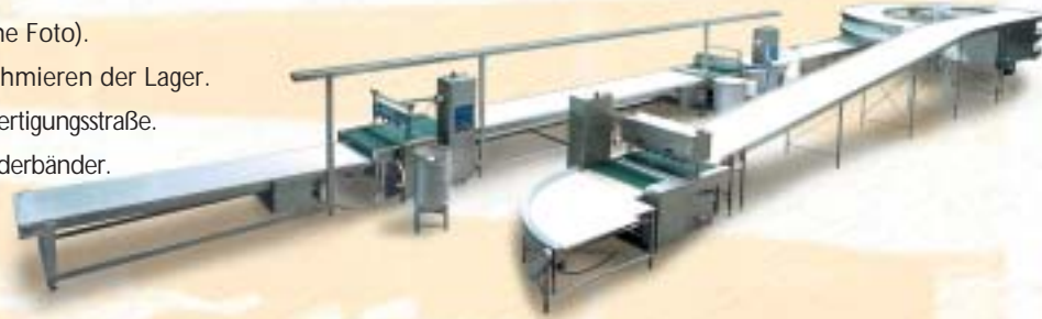
Anlage für das Auftragen von Fondant, Marmelade und Spezialüberzug
